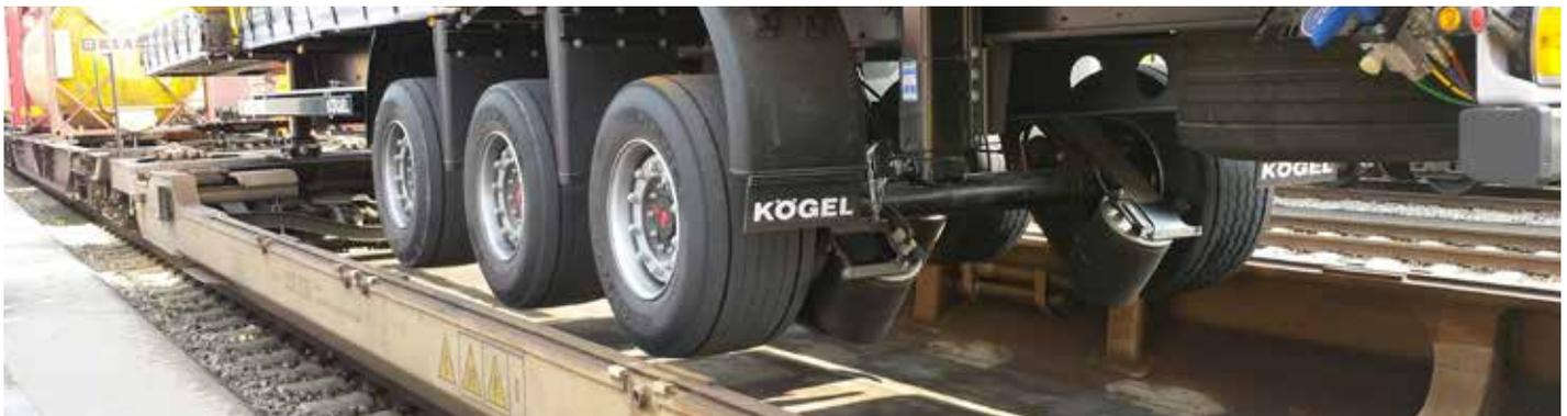
Кодовый номер ж/д полосы полуприцепа непосредственно зависит от общей высоты полуприцепа в вагоне с нишами для колес. Железнодорожный код определяет, по каким железнодорожным линиям можно перевозить транспортное средство.
