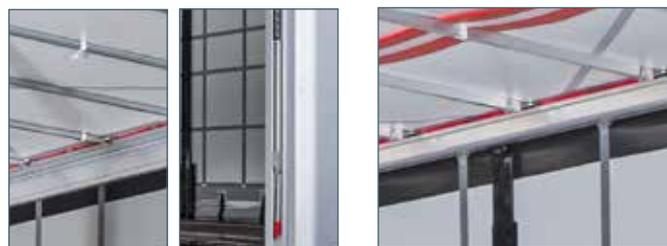
Увеличение боковой погрузочной высоты для погрузки сбоку с одновременным увеличением ширины грузовой платформы до самой крыши благодаря 163-миллиметровому L-образному профилю бруса крыши
