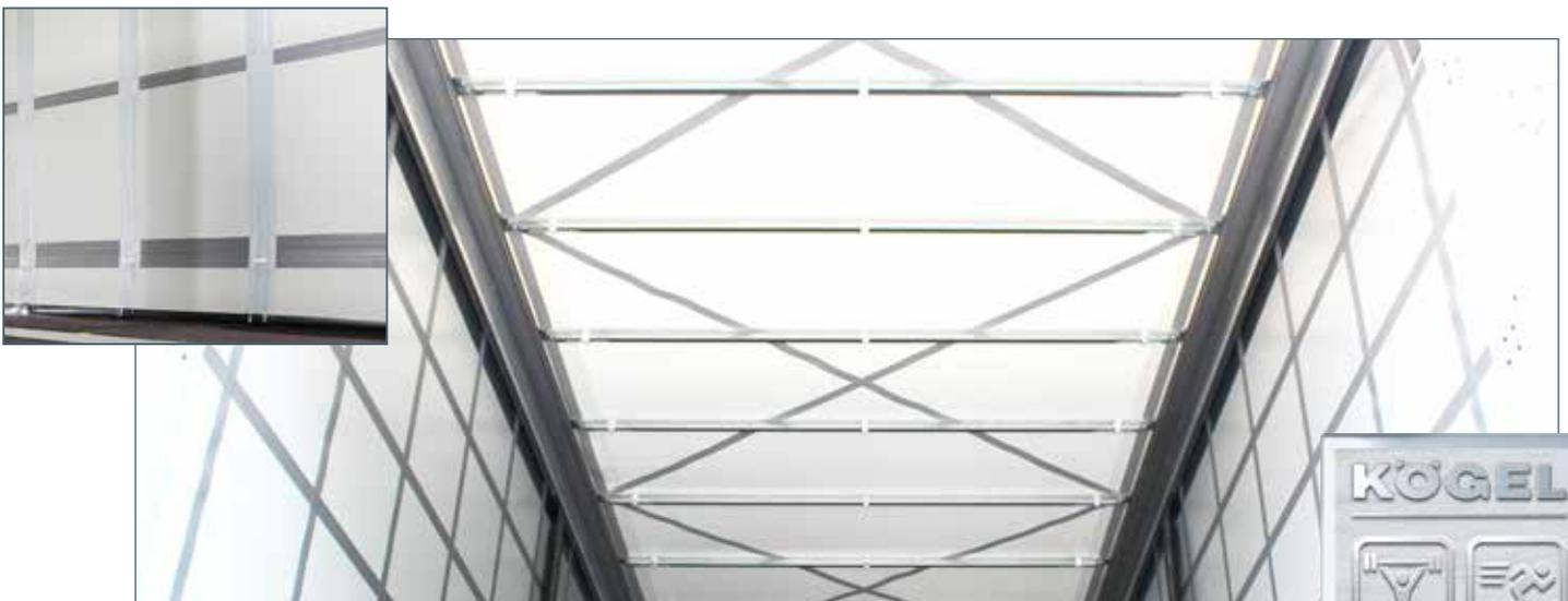
Благодаря встроенной в тент удерживающей системе возможна перевозка напитков в один и два уровня без обрешетки каркаса.
