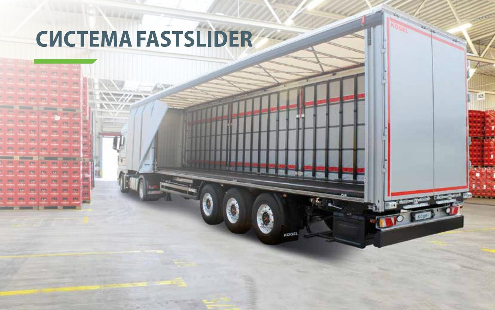
Kögel FastSlider — это легко и быстро открывающиеся и закрывающиеся сдвижные тенты, разработанные для упрощения ежедневных операций. Будучи доступной с обеих сторон либо слева по направлению движения, система FastSlider очень гибко адаптируется к разным логистическим задачам, будь то перевозки для автомобилестроительной отрасли, перевозки напитков или перевозки на поддонах.
