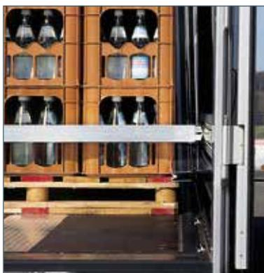
**Крепление грузов при неполной загрузке с помощью двухсторонних планок:**
