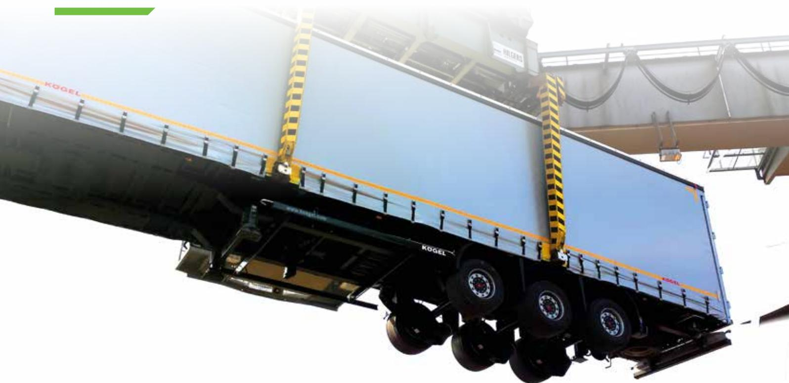
В двух словах об исполнении Rail седельного полуприцепа можно рассказать так: седельный полуприцеп, который грузится в железнодорожный вагон при помощи крана, должен быть оснащен специальным образом.
