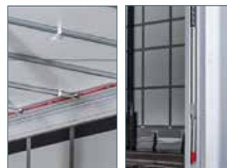
Увеличение боковой погрузочной высоты для погрузки сбоку с одновременным увеличением ширины грузовой платформы до самой крыши благодаря 163-миллиметровому L-образному профилю бруса крыши
