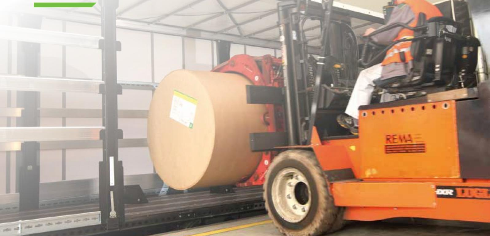
Перевозка бумаги — один из сложнейших видов перевозок, поскольку бумажные рулоны, во-первых, тяжелые, а во-вторых, подвержены повреждениям под воздействием влаги и механических нагрузок.
