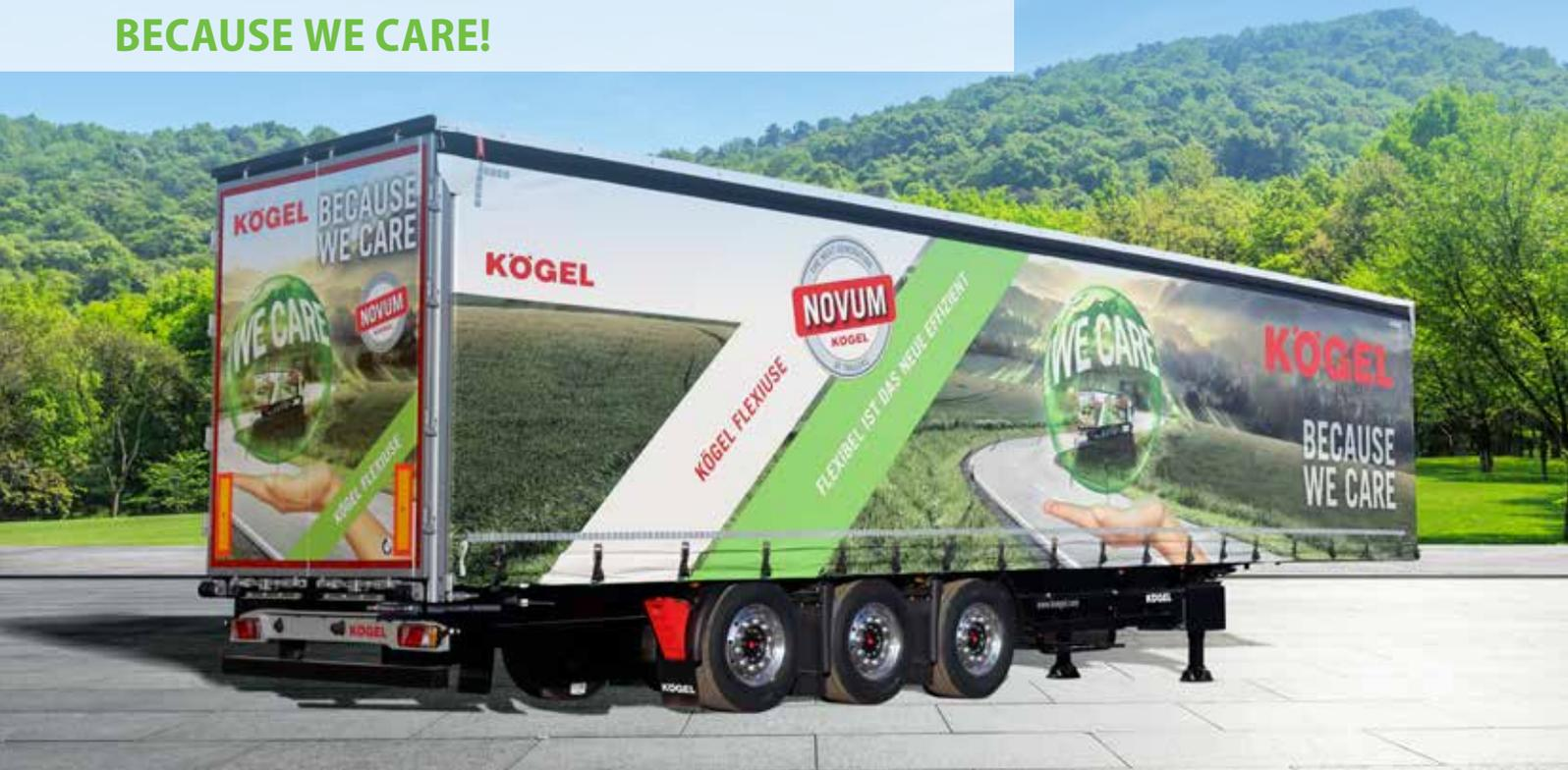
Kögel FlexiUse — здесь название говорит само за себя. Благодаря специальной ходовой части этот полуприцеп подойдет к тягачам с разной высотой седельно-сцепного устройства. При этом за счет кузова с регулировкой по высоте полуприцеп FlexiUse можно адаптировать под конкретную высоту седельно-сцепного устройства, чтобы не превысить допустимую общую высоту. За счет этого трейлер не только решает еще больше транспортных задач, но и экономит время и деньги перевозчиков.
